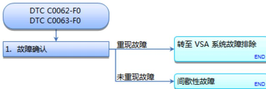
**DTC C0062-F0:** 纵向加速度传感器故障
